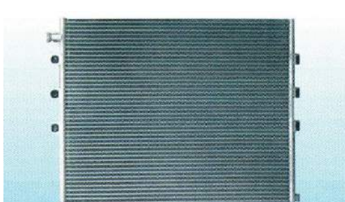
适用车型：德龙 3000（新款）冷凝器 芯体尺寸：619*440*20 备 注：进 4 分环保外牙 / 出 3 分环保外牙
